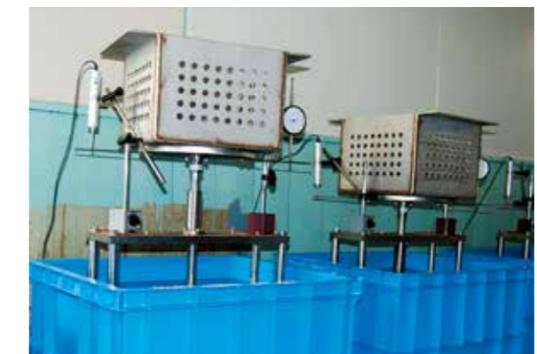
水中クリープ試験 (曲げ弾性率) JIS K 7035
