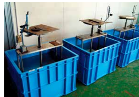
水中クリープ試験 (曲げ強さ) JIS K 7039
