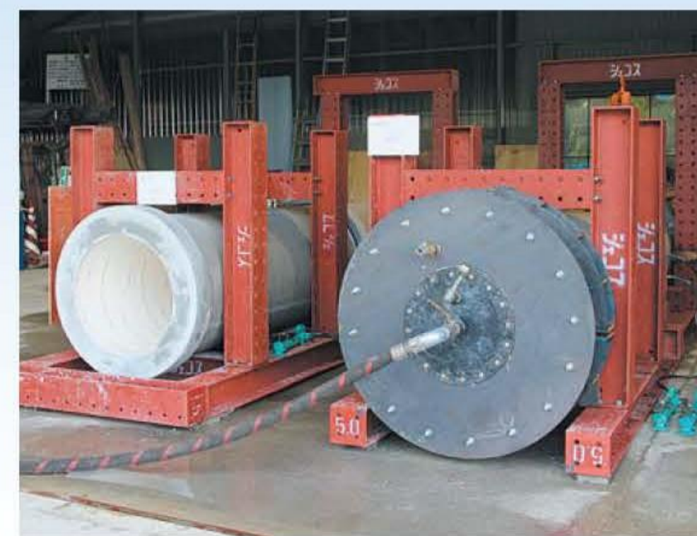
管軸方向の耐震性試験（レベル1）
